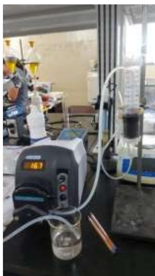
Figura 4: Montaje del reactor tubular para los ensayos de adsorción
