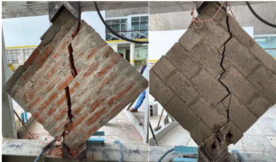
Figura 7. Falla por tensión diagonal en muretes de ladrillo y bloque
