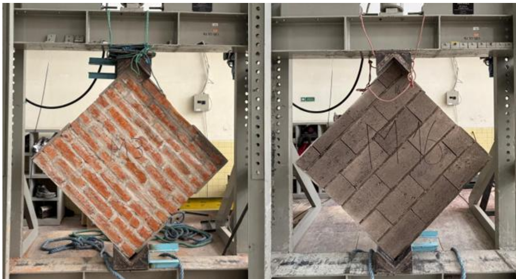
Figura 4. Ensayo de compresión diagonal a muretes de ladrillo y bloque
