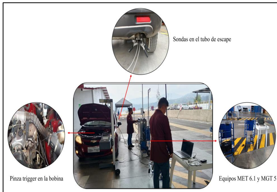
Figura 1. Disposición de los instrumentos de medición en una línea de RTV.
